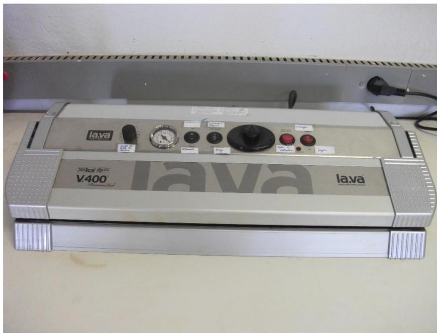
**Figura 3: Seladora a vácuo LA.VA-
