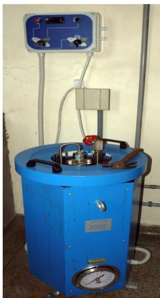
**Figura 7: Reator de Carbonização Matest, modelo E070X, Itália.**
