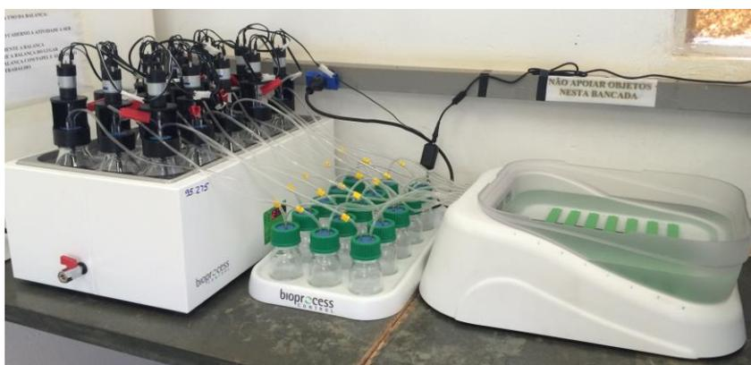
**Figura 4: Sistema de Teste de Potencial Metanogenico, marca (BIOPROCESS CONTROL- Suecia), modelo AMPTS II, instalado no laboratório conjunto de biogás do IFG e da UFG.**
