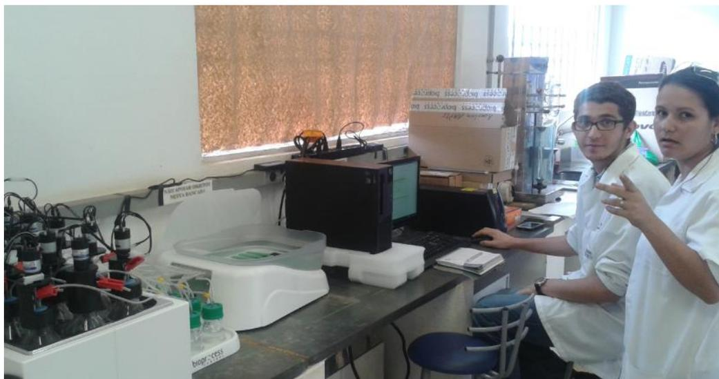
**Figura 8- Montagem do Sistema AMPTS II.**
